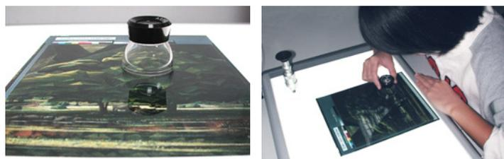
圖 5-2、運用 15 倍以上之固定焦距放大鏡檢視成果
