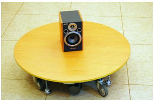
圖 4-28：電動水平旋轉台讓物體每次旋轉 10 度以達到精準的環物攝影
