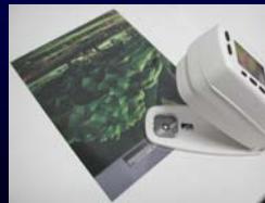
測量數位輸出列印稿之反射式分光密度儀 台藝大圖文系A.C.T Media Lab 謝顯丞、鄭惠文
