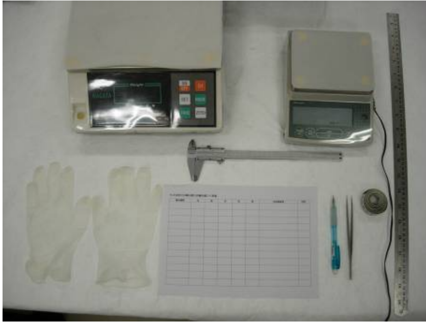
圖十八、文物尺寸測量與記錄工具（圖片提供：國立臺灣博物館）
