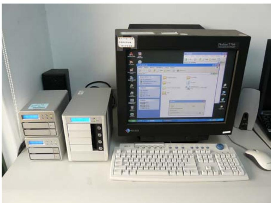
圖十七、網站備份用外接式硬碟。
