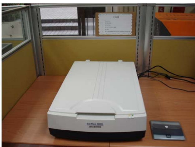
圖五、A3 規格平台式掃描器，旁為擦拭掃描器鏡面之奈米布。
