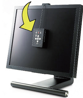
圖4-10、線控簡易置於螢幕前校正。 ⑩
