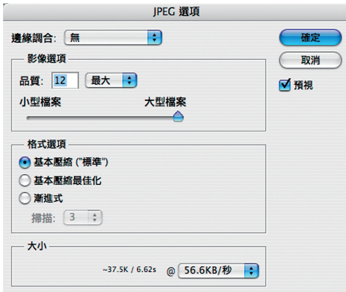
圖1-4、JPEG檔案格式可以選擇不同品質的壓縮比例，檔案小者，壓縮比例大影像品質差；檔案大者，壓縮比例小影像品質佳。 ④
