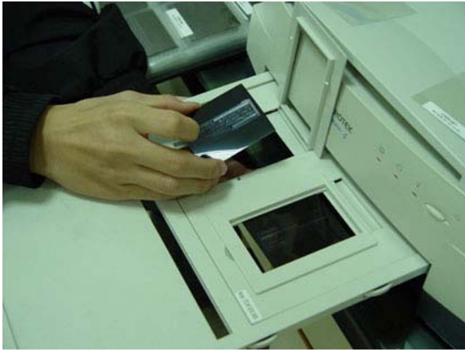
圖九、將岩心標本正片置入 Microtek 正負片掃描器中
