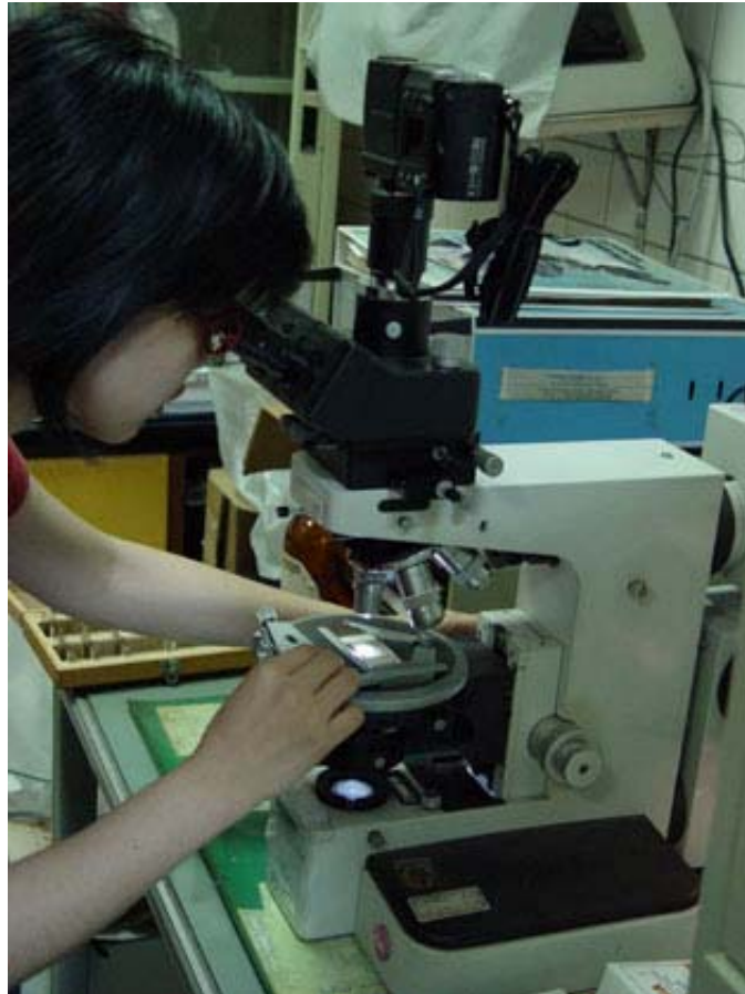
圖二十八、利用偏光顯微鏡進行岩石薄片拍攝(示範者：陳俐陵)
