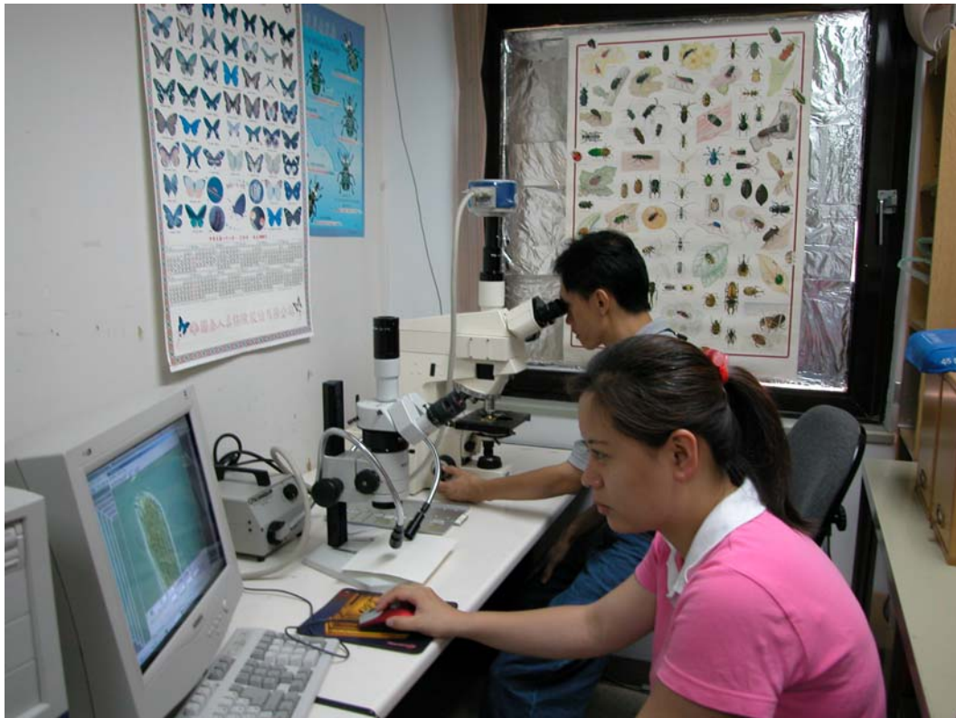
圖九、使用影像擷取系統拍攝微型及玻片標本， 並利用 AutoMontage 軟體處理影像疊圖
