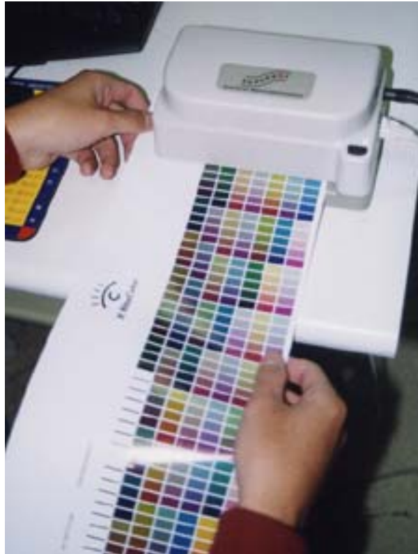
圖二十九、操作分光光度儀，檢測數位樣
