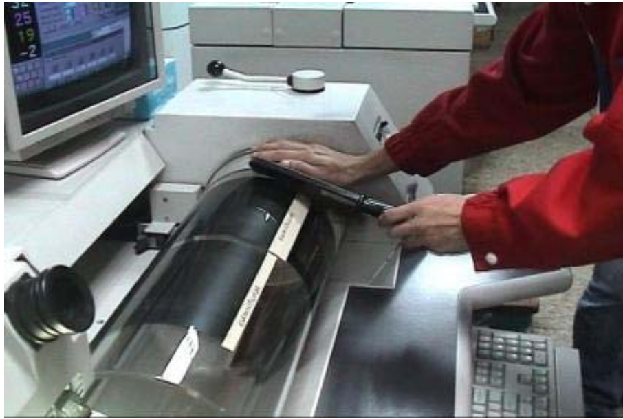
圖五、貼於滾筒後使用防靜電刷掃除底片灰塵
