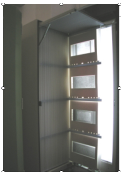
圖十八、具溫濕控制功能與覽片設計之底片櫃
