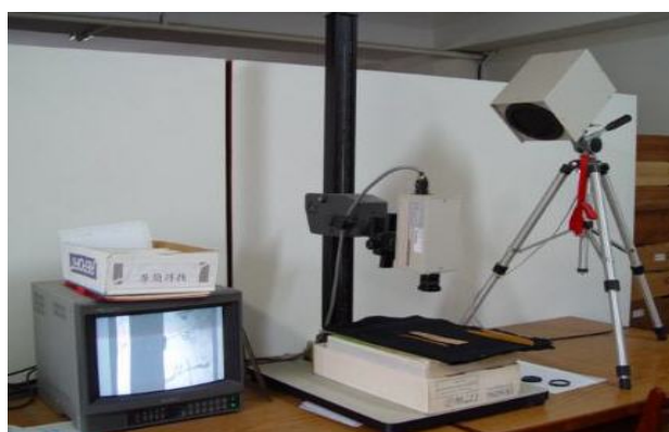
圖十、漢簡紅外線攝影儀設備
