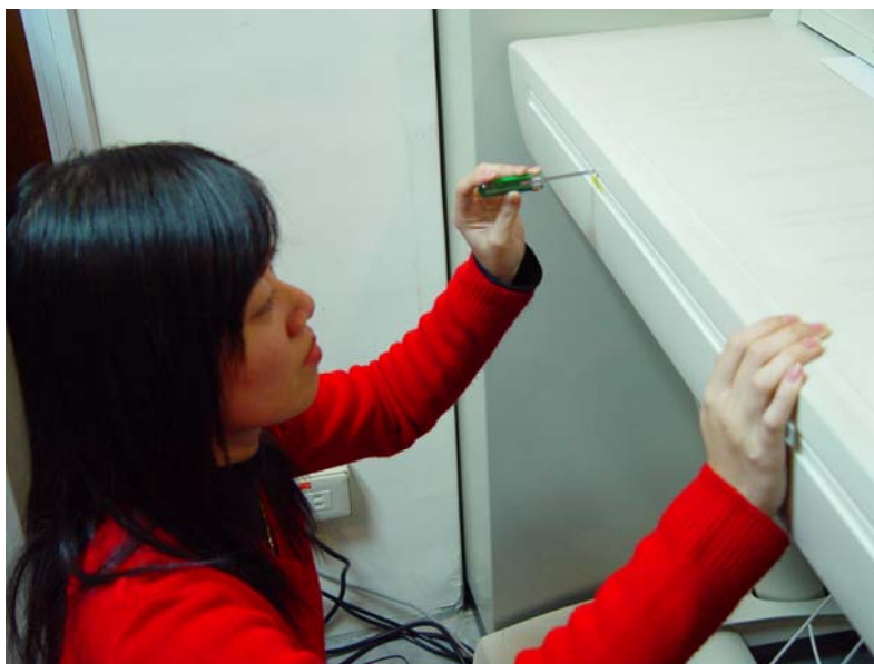
圖二十、將螺絲起子插入掃描器的校正孔中，並依軟體指示轉動方向(示範者：陳瑛芳)
