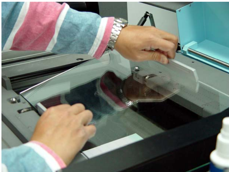
圖五十二、將校正用的玻璃板放入掃描器中標記的位置
