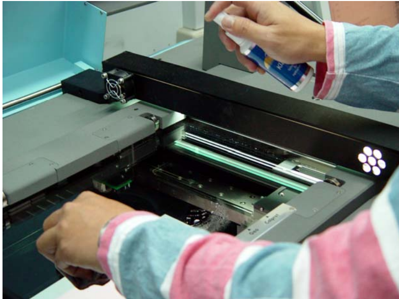
圖五十一、使用清潔液擦拭掃描器內的玻璃
