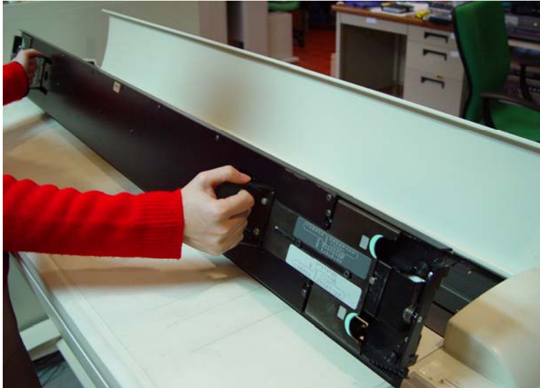
圖十八、將掃描器內部拆開清潔
