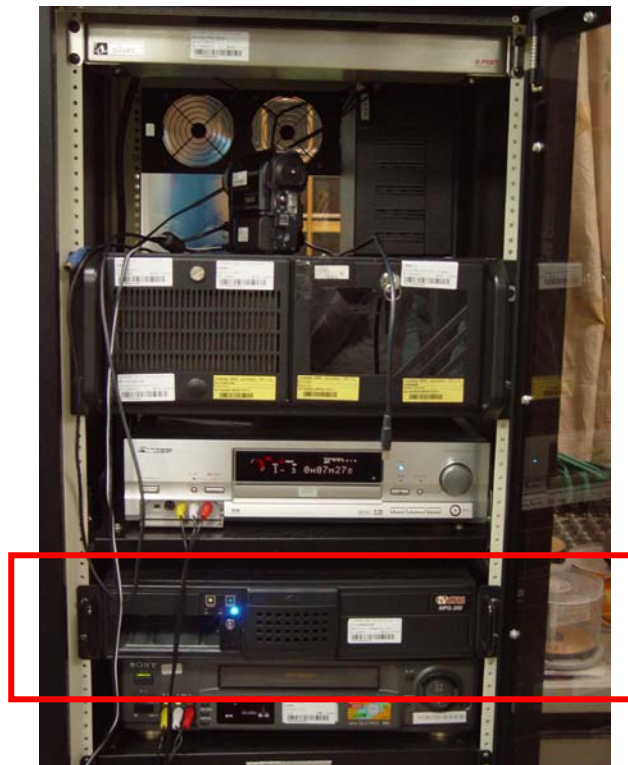
圖七、利用 FS-MPEG 硬碟錄放影機轉檔。
