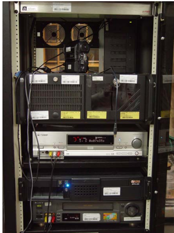
圖四、類比影片轉檔所需之各項硬體設備。
