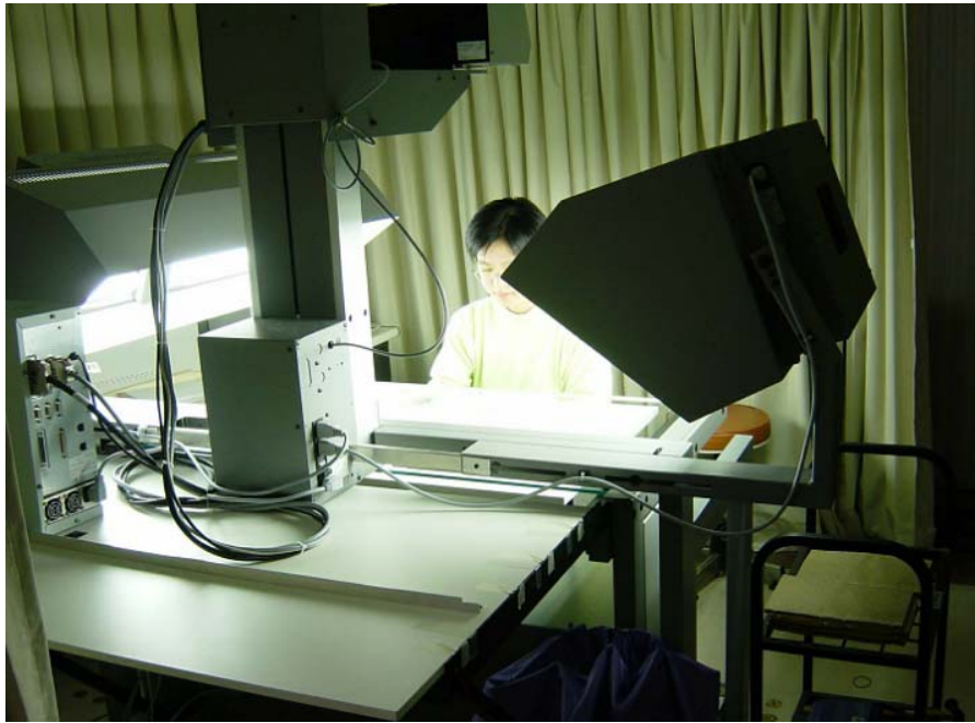
圖七、掃描器自兩邊打光，鏡頭在上，由工作人員操作掃描
