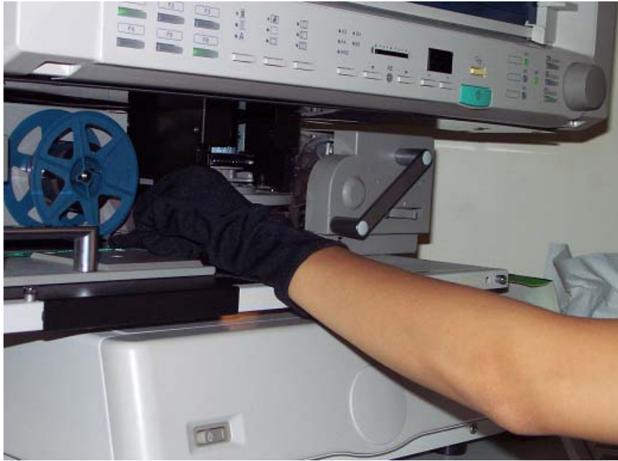
圖九：將微卷置入微縮影片掃描機
