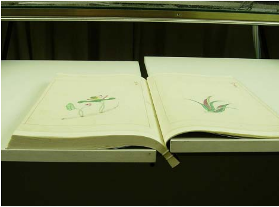
圖五、採用特殊平台，使書不必拆線而能平置於掃描台上
