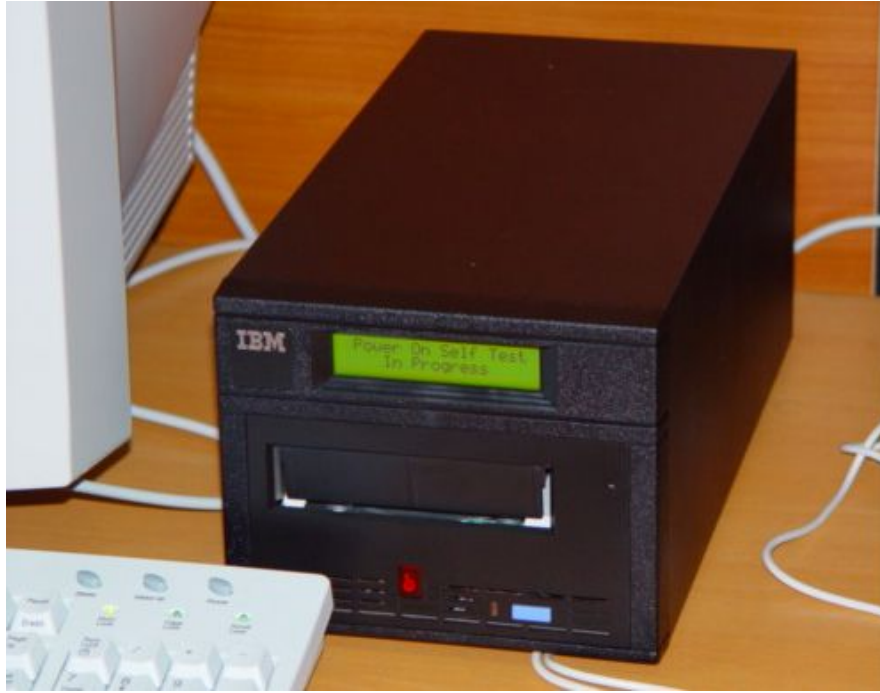
圖十二、轉錄磁帶所使用的磁帶機
