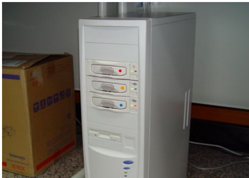
圖十、三顆存檔用的抽取式硬碟，由上而下分別為一 紅色為儲存 300dpi、TIFF 格式檔案； 橘色為儲存 300dpi、JPG 格式檔案； 藍色為儲存 76dpi、網路瀏覽規格
