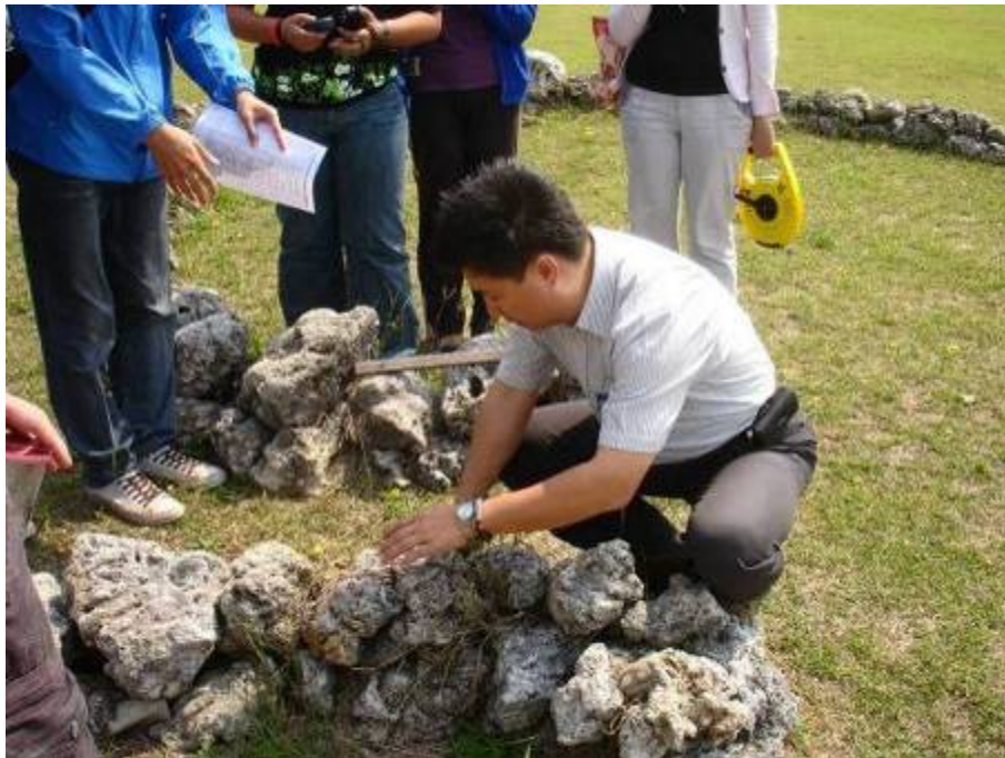
圖 18 模擬石滬測量（長、寬、高、方位、GPS 定位等） （示範者：李明儒老師）
