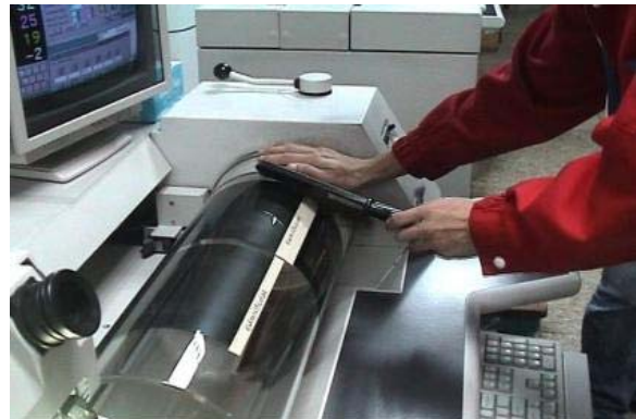
圖三十六、貼於滾筒後使用防靜電刷掃除底片灰塵(廠商)
