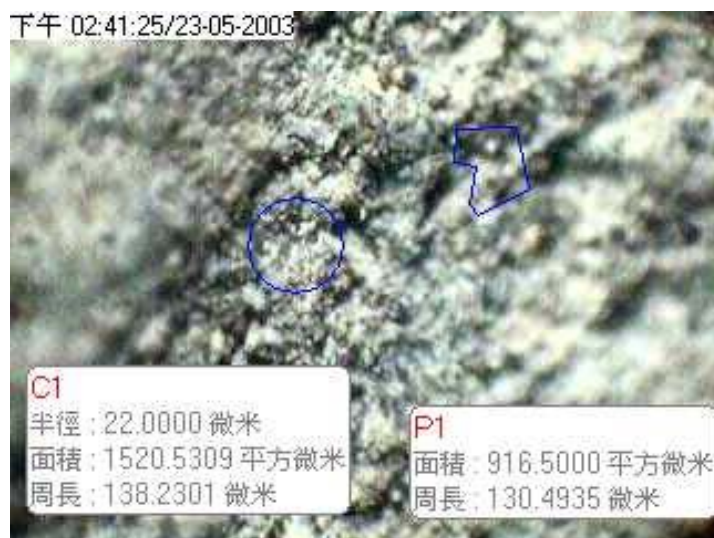
圖二十、測量軟體計算成分顆粒的直徑與面積
