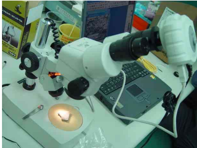
圖十九、利用 CCD 接頭將觀察影像傳至電腦
