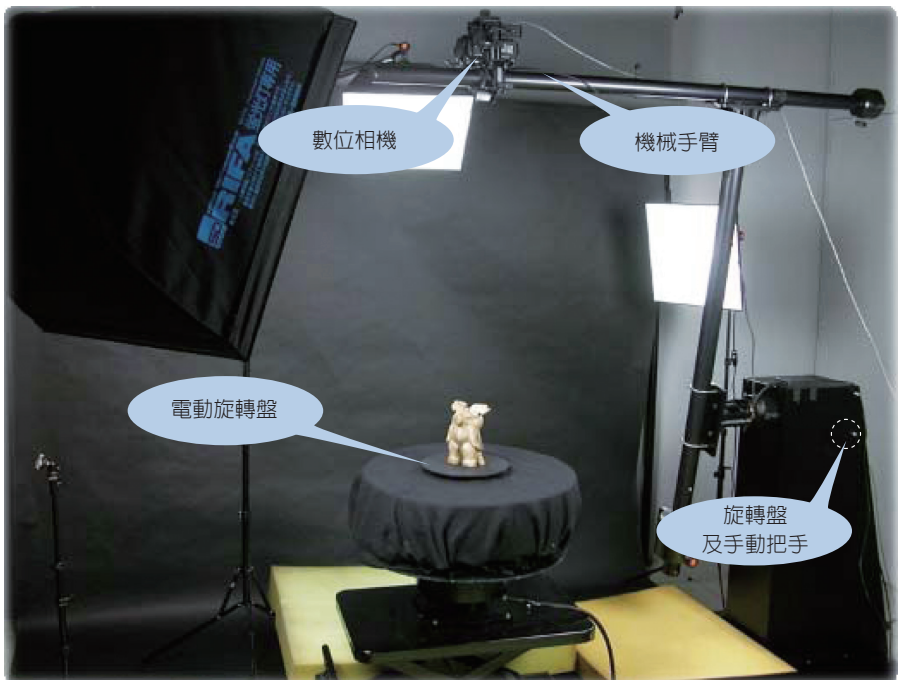
圖4-1：設備組件有：數位相機、機械手臂、旋轉盤及手動把手、電動旋轉盤 資料來源：中研院史語所數位知識總體經營計畫分支一：考古發掘遺物、照片、記錄與檔案
