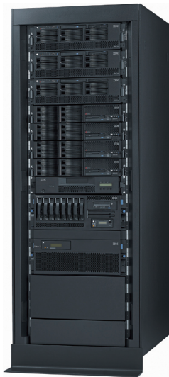
圖5-6、安裝於機櫃內的機架式伺服器
