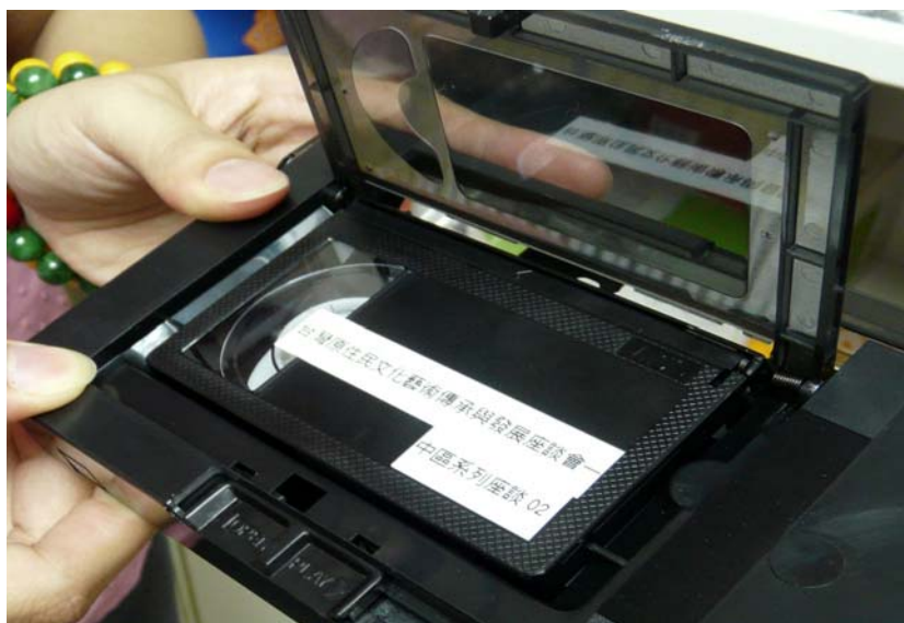
圖七、使用轉換匣將 VHS-C 母帶轉換成 VHS 帶
