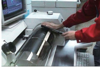
圖4-2、貼於滾筒後使用防靜電刷掃除底片灰塵 14
