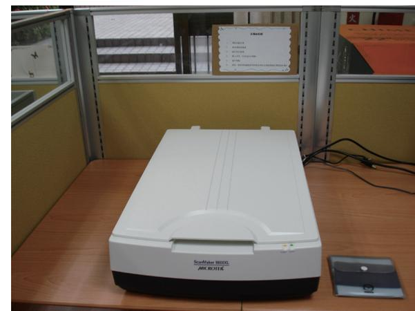
圖6-1、A3規格平台式掃描器，旁為擦拭掃描器鏡面之奈米布。
