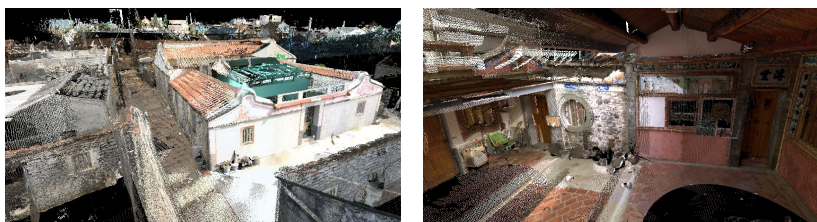
圖5-2-20、掃描點雲圖資（望安澎湖花宅地面），室外部份（左）及室內部分（右）
