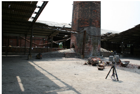
圖5-2-8、古蹟變形監測：建置後續3D基準點法比對（共軌點法）模式，利用固定的基準點即為坐標轉換比對法。未來只要基準點不受破壞，即可精確快速的資料比對（臺灣煉瓦株式會社高雄工場（唐榮中都磚窯廠），高雄，1913）
