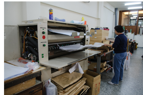
圖4-1-2、設計圖原稿經由曬圖機輸出藍曬圖
