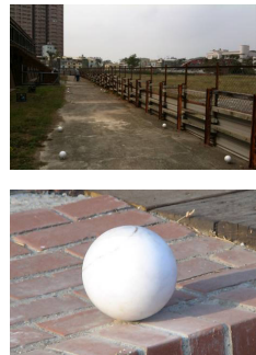
圖5-2-8、古蹟變形監測：建置後續3D基準點法比對（共軌點法）模式，利用固定的基準點即為坐標轉換比對法。未來只要基準點不受破壞，即可精確快速的資料比對（臺灣煉瓦株式會社高雄工場（唐榮中都磚窯廠），高雄，1913）
