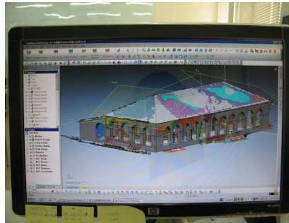
圖6-2-12、將點雲檔匯入 Rapidform XOR2建置3D模型
