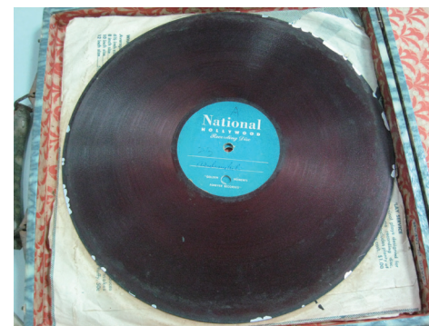
圖1-5、《南島語族音樂數位博物館計畫》於2010年自帛琉攜回之即時錄音唱片。唱片邊緣的漆質已有剝落現象，急需數位化轉製。即時錄音唱片圓標有如CD-R空白光碟片，可供錄音者填寫錄音的基本資訊
