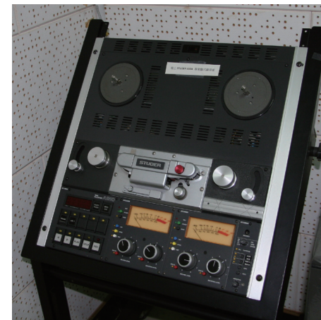
圖2-9、《南島語族音樂數位博物館計畫》所使用，德國音響專業大廠Studer公司製造的兩軌盤機A810。具有以下優點：1. 盤帶通道處有較多的輔助輪軸，減低對盤帶造成的拉扯；2. 轉速有3.75ips、7.5ips、15ips與30ips四種選擇；3. 附有盤帶修補剪輯區
