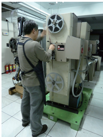
圖1-3、35mm與16mm雙規格膠片放映機 (示範者：電影資料館鄧榮平)
