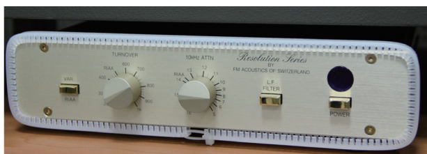
圖3-1、瑞士FM acoustics公司製造的122 MKII唱頭放大器，具有歷史曲線調整功能。
