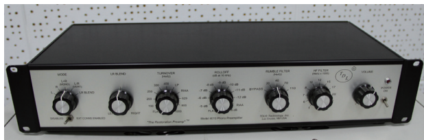
圖3-7、美國TDL公司生產的4010 Restoration 唱頭放大器，其面板上有七個調整鈕讓使用者可以調整出理想的歷史曲線
