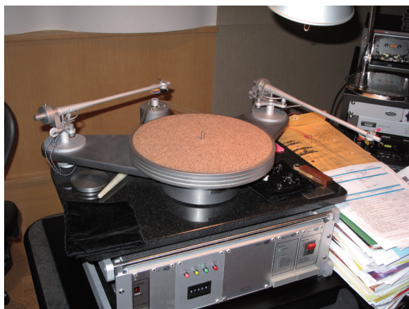
圖2-5、美國國會圖書館國家音像保存中心(Library of Congress National Audio Visual Conservation Center) 15 使用的雙唱臂（12吋）唱盤系統，轉盤右邊黑布盒上放著各種不同規格的唱針，可針對唱片情況更換以獲得最佳的播放效果。下方機器是具轉速調整的電源控制器，適用於任何轉速唱片
