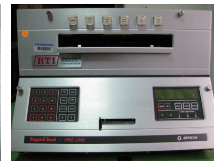
圖2-9、進行修護時的設備-消磁、洗帶機 資料來源：財團法人國家電影資料館
