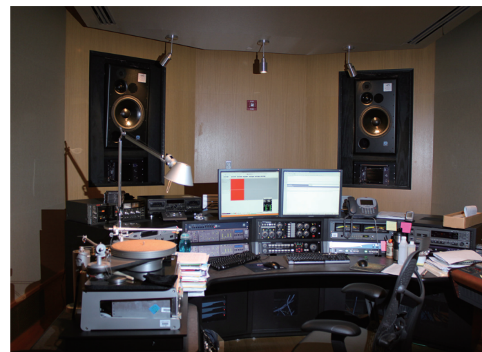
圖3-17、NAVCC的類比載體數位化工作室，備有完整的自動化工作流程系統。一張唱片或一卷磁帶數位化後會由系統自動找出原始的目錄資料來建檔，並儲存成典藏母帶檔以及公共瀏覽格式，傳送到伺服器上保存和提供聆聽服務
