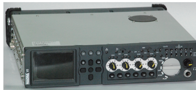
圖3-12、瑞士音響公司Nagra生產的Nagra VI六軌數位錄音機。內建500G硬碟與品質極佳的A/D轉換器，可直接輸入唱頭放大器類比訊號並儲存成IASA建議的24bit/96kHz BWF.wav數位檔
