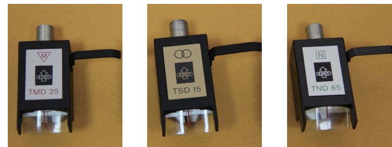
圖2-7、播放不同唱片使用的EMT MC型唱頭，型號數據代表唱針的直徑（以微米 \mu\text{m} 計量），溝槽愈密，用的唱針直徑愈小（由左至右為播放單聲道(Mono)密紋唱片、播放立體聲(Stereo)密紋唱片、播放78轉唱片）
