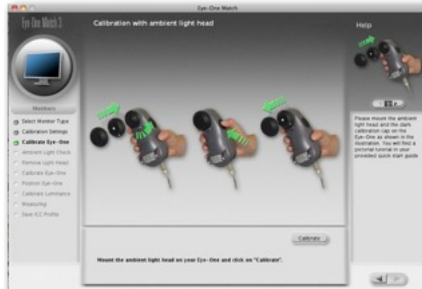
裝載環境光源的套件以校正儀器
