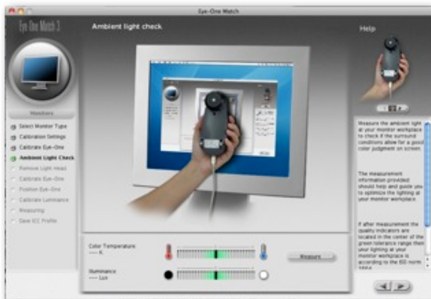
量測照明光源的色溫與照度值表現
