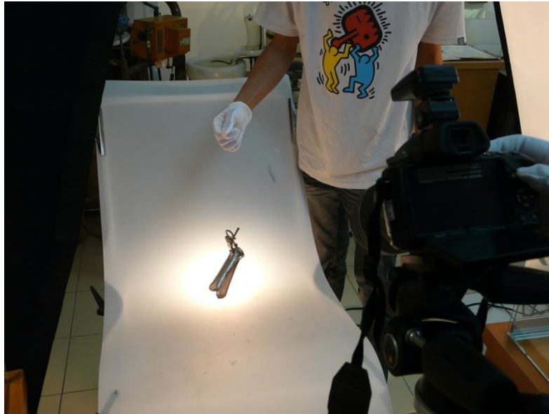
圖 11：隨物體大小變更焦段以及腳架位置以確保物體影像放大率（避免小型文物細節不足），同時隨文物調整棚燈出力（大型物件需要增加出力（示範者：戴碩良、曾繁凱）
