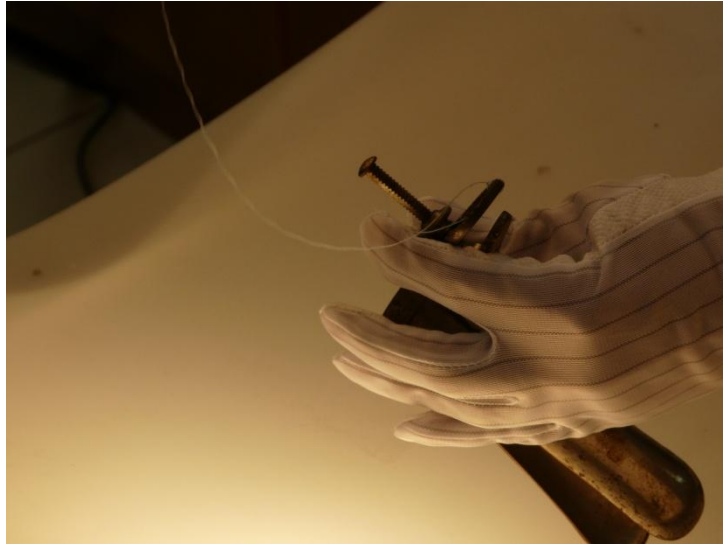
圖 9：將吊繩掛至文物物件的後方拍攝，不會干擾影像以利之後的去背作業（示範者：戴碩良）
