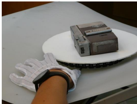
圖 12-13：先旋轉一圈確認物體置於轉盤軸心，接著維持設定連續拍攝旋轉一周。拍攝後連續播放影像確認曝光成果均相同，若有燈光出力不足則旋轉回該角度補攝（示範者：戴碩良）
