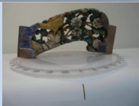
圖 12：桌上型水平轉盤，依轉盤刻度每 10 度拍攝一張
