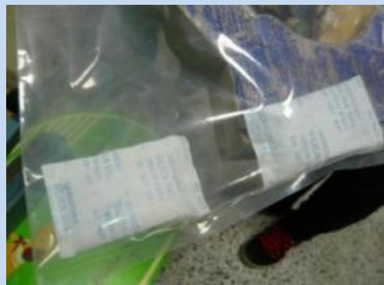
圖 16：以中性/PE 塑膠袋（厚度 0.1mm 以上）封裝，並放置乾燥劑
