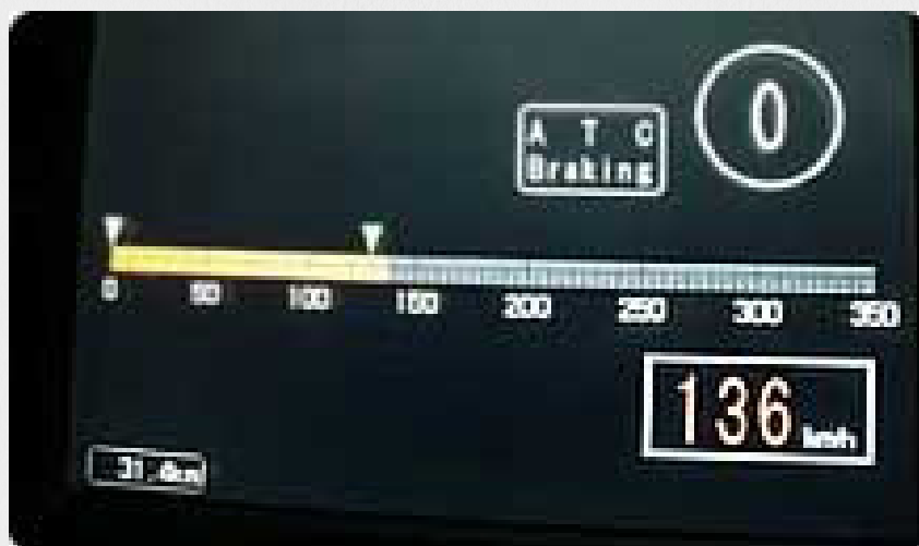
圖 02：〈ATC ( Automatic Train Control ) 列車自動控制系統〉。圖片提供者：臺灣高速鐵路股份有限公司。網站名稱：臺灣高速鐵路股份有限公司。
