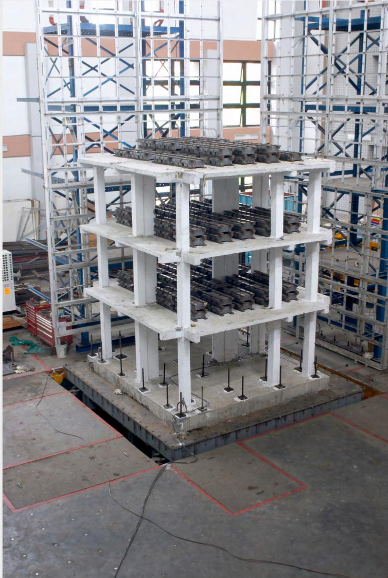
圖 01：地震模擬實驗室的地震模擬振動臺共擁有六個自由度，以模擬三軸向之地震。目前發生在世上主要地震均能在地震模擬實驗室模擬重現。〈地震模擬振動台〉。圖片提供者：國家地震工程研究中心。網站名稱：國家地震工程研究中心。
