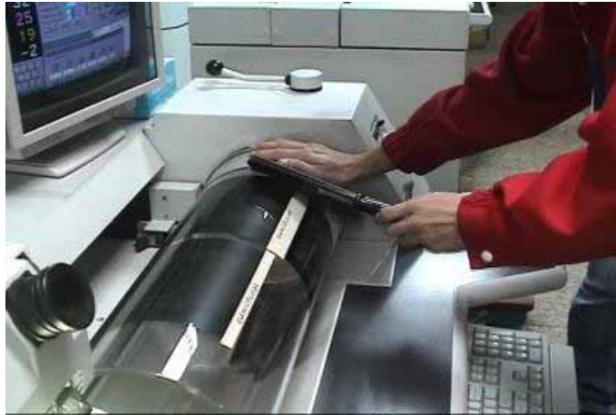
圖二、貼於滾筒後使用防靜電刷掃除底片灰塵 15
