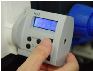
HIP(Human Interface Panel)，可以控制變倍及調焦、
