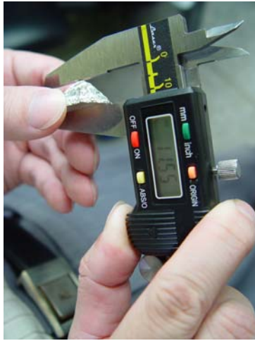
測微器(游標尺)：測量貝殼長度(精確度可到小數點二位數)
