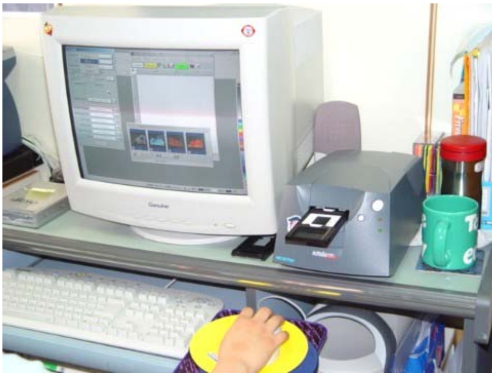
圖十六、使用 Microtek ArtixScan4000t 之底片及幻燈片專用掃描器，一次可掃四張幻燈片。
