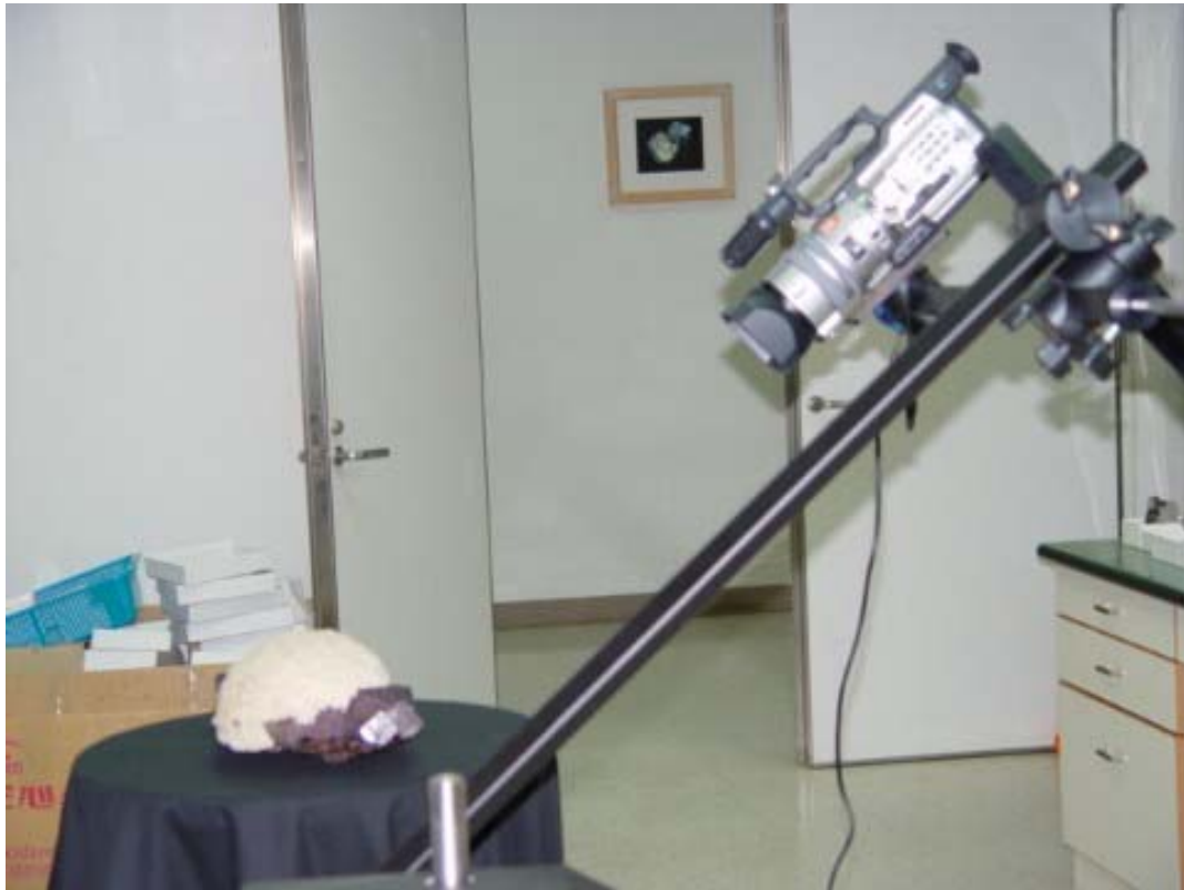
圖十二、環物攝影一隅。當攝影機架妥後，在電腦軟體控制下，機械手臂、轉盤一次可旋轉 15 度或 30 度。
