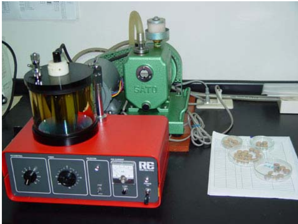
圖二十九、微體化石標本表面鍍膜器材(左)，右為待鍍膜標本櫃。
