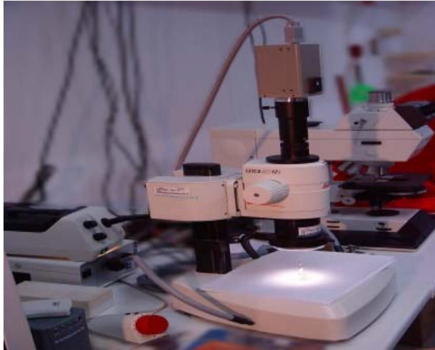
圖三十九、Leica 顯微鏡及數位攝影機
