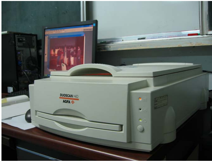
圖八、掃描器採用印刷等級之平台掃描器機種
